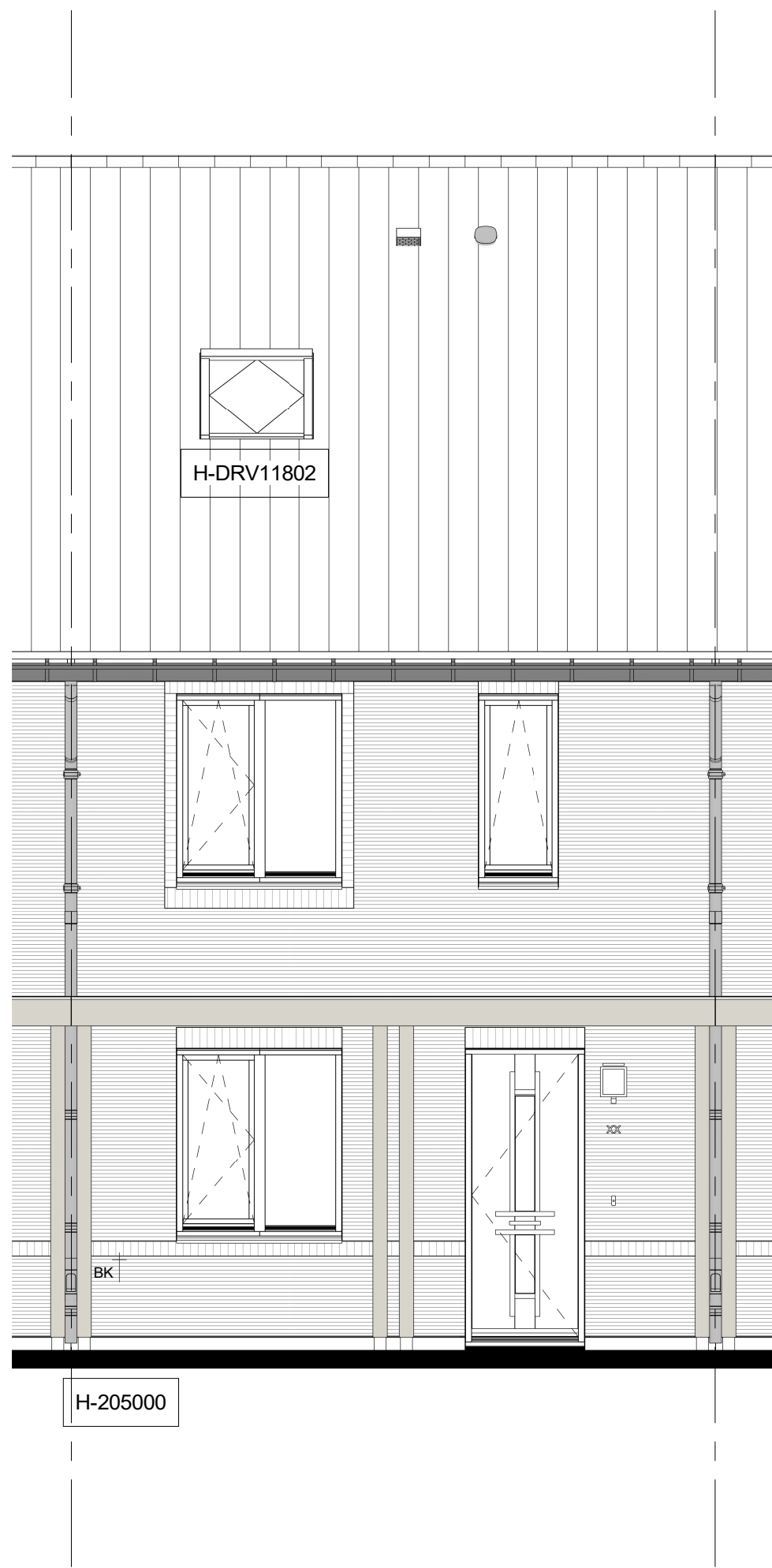
H-DRV11802 Dakraam 940x1.180 mm (v.z.v. Triple glas) in de voorgevel t.p.v. de onbenoemde ruimte (boven slaapkamer 2) H-205000 Buitenkraan in de voorgevel
